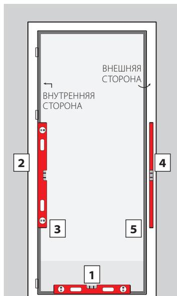
**! Отклонение от вертикали и горизонтали дверной коробки не должно превышать 2 мм.**
